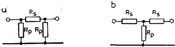
3.124. Podstawowe ogniwa tłumika rezystancyjnego: a — układ typu \pi , b — układ typu T
